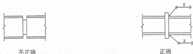
图 4.2.5-2 对接构件间连接板构造
