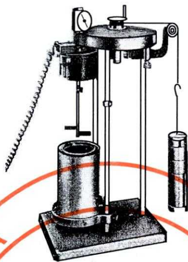
图1 带桨叶式转子和频闪计时器的斯托默黏度计
