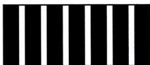
图 3 计时器调至 200 r/min 时的频闪线条
